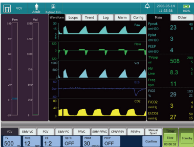
Modo de ventilación integral, que incluye VCV, PCV, SIMV-VC, SIMV-PC, CPAP/PSV, PRVC, SIMV-PRVC y PSVPro. Visualización de cinco formas de onda, que incluye Paw, Flujo, Vol, EEG y CO 2 . automática del gas y cálculo Mac.
