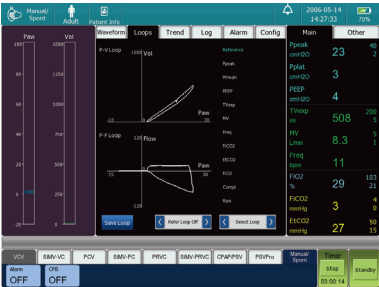
La medición en tiempo real de la presión de las vías pulmonar y la fuera de la respiración ofrecen una herramienta intuitiva para detectar fugas, obstrucción de las vías respiratorias y ajuste óptimo de los parámetros de ventilación.
