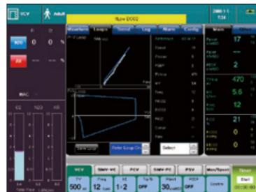
La medición en tiempo real de la presión de las vías respiratorias, el flujo, los volúmenes, el cumplimiento y la resistencia de la respiración ofrece una herramienta intuitiva para detectar fugas, obstrucción de las vías respiratorias y un ajuste óptimo de los parámetros ventilados
