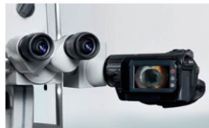
Sistema DigiCam con cámara convencional
